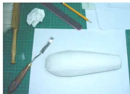
Anschließend wurde der Körper geschliffen, damit dieser als Positivform zur Erstellung zweier Silikon-/Gips-Negativformen genutzt werden konnte
