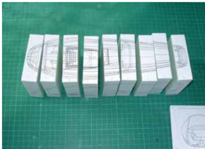
nach Abtragen des überschüssigen Materials wurden die Einzelteile geklebt. Die Oberfläche wurde geschlichtet und verbliebene Unebenheiten mit Acrylpachtel geglättet
